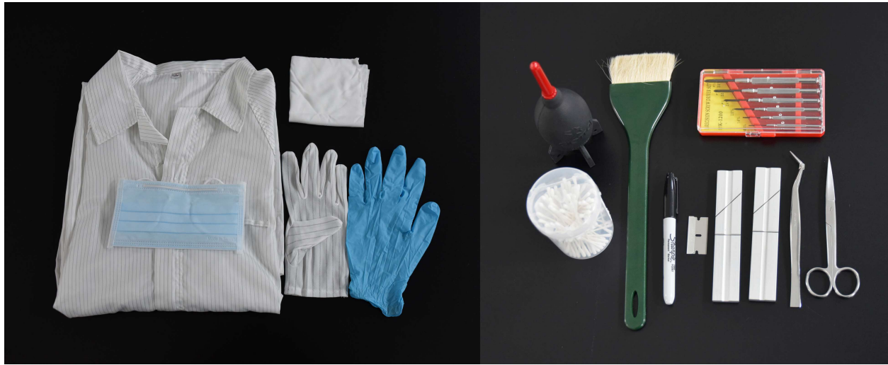
圖1 口罩、防塵衣、無絨毛清潔用布、手套（左）；除塵用具、標記用筆、螺絲套組、切割墊、切割刀片、攝子、剪刀（右）
