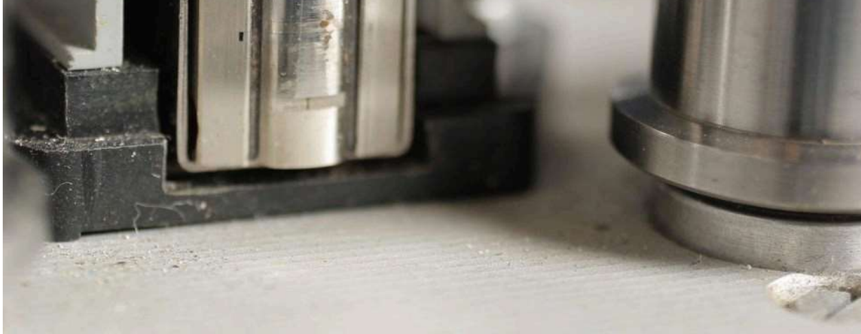
圖2 沾黏磁粉之盤機磁頭
