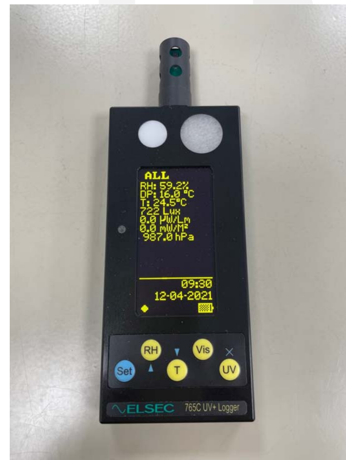
圖23 四合一量測器 (紫外線、照度、溫度、溼度)
