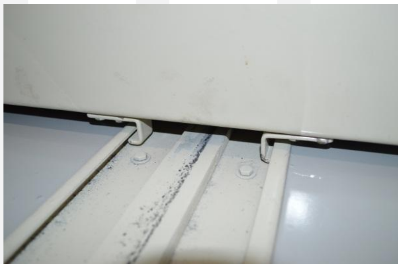
圖39 密集式檔案架防傾倒卡樺
