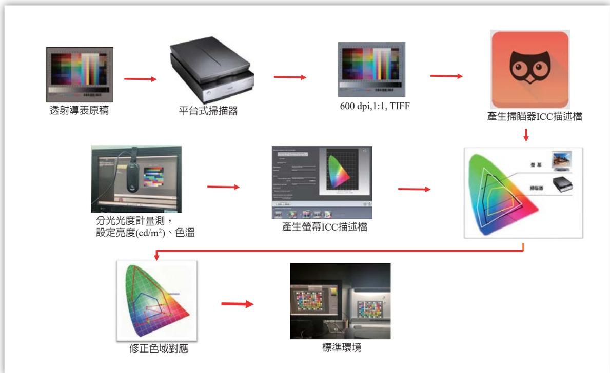
圖 13 色彩設備特性與轉換流程
