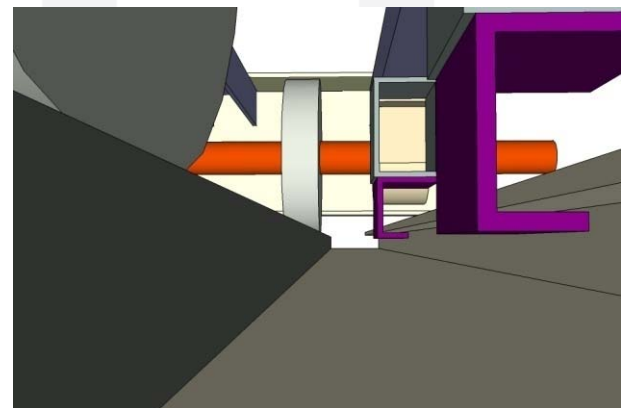
密集式檔案架防傾倒卡榫示意圖
