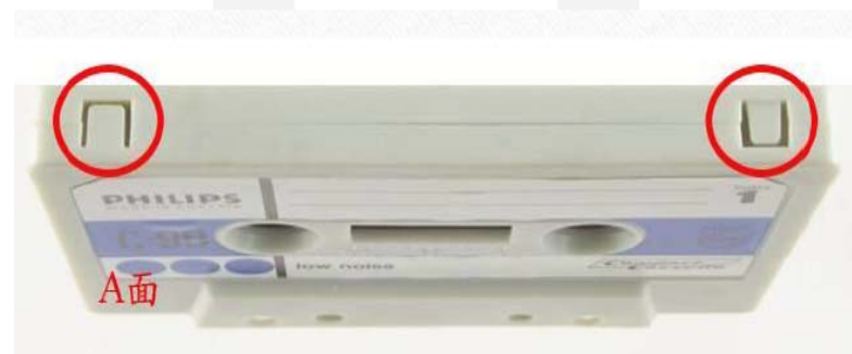
圖例1 目前此捲空白卡帶為A面，上面分別有2個防寫裝置，左邊是A面的防寫片、右邊是B面的防寫片。
