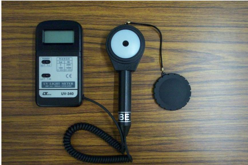
圖21 紫外線量測器
