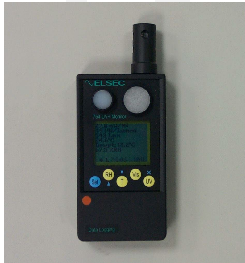
圖23 四合一量測器 (紫外線、照度、溫度、溼度)
