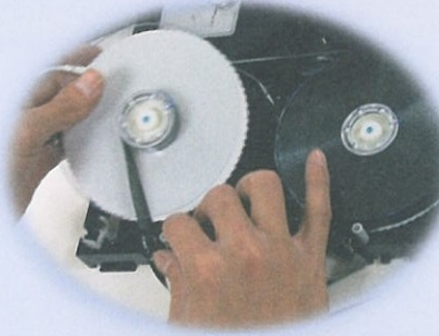
6. 將帶盤放入卡匣並調整至正確位置
