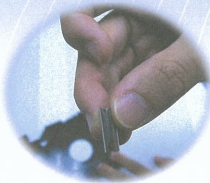
7. 將不鏽鋼滑軸接縫處朝內
