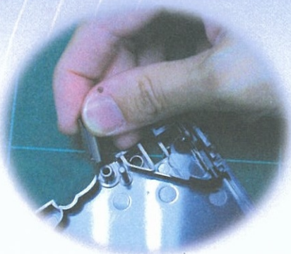
8. 將不鏽鋼滑軸置於軸承上
