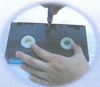
16. 檢視外殼接縫處是否平整並鎖上螺絲
