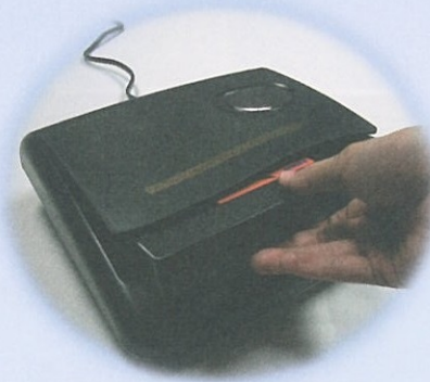
3. 將磁帶放入迴帶機，利用迴帶機快速迴帶與過帶的轉動效果，使黴菌脫離磁帶
