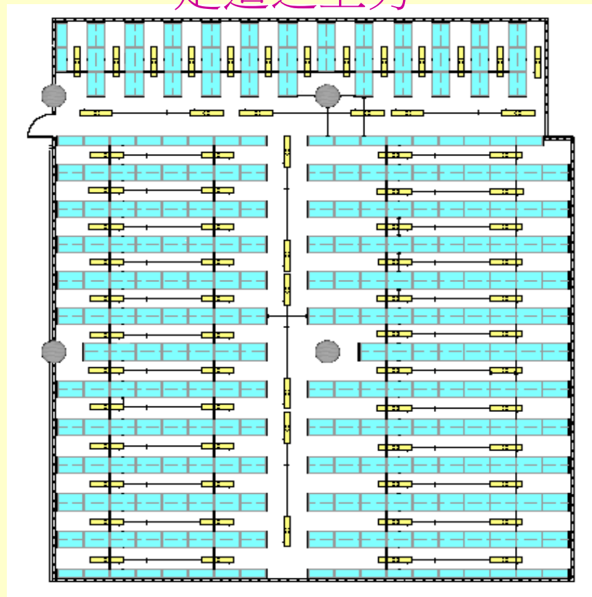
圖25-照明燈具安裝方向(固定式檔案架)
