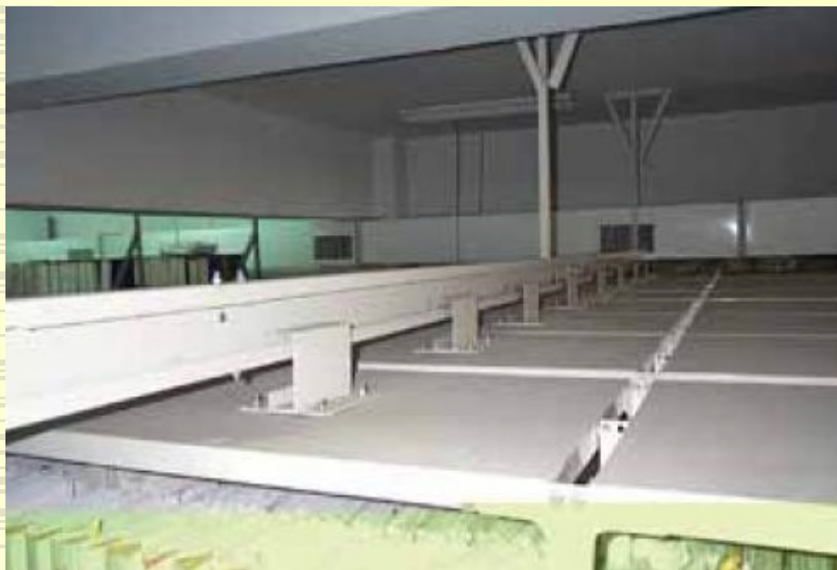
圖38密集式檔案架防傾倒連桿
