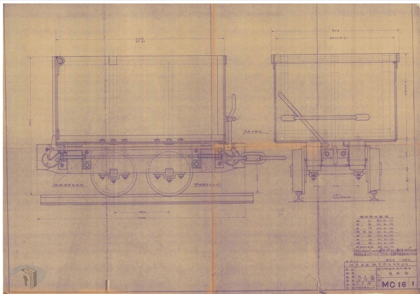
圖6 1959年一噸載重鑛車鐵片鑛車裝配圖
