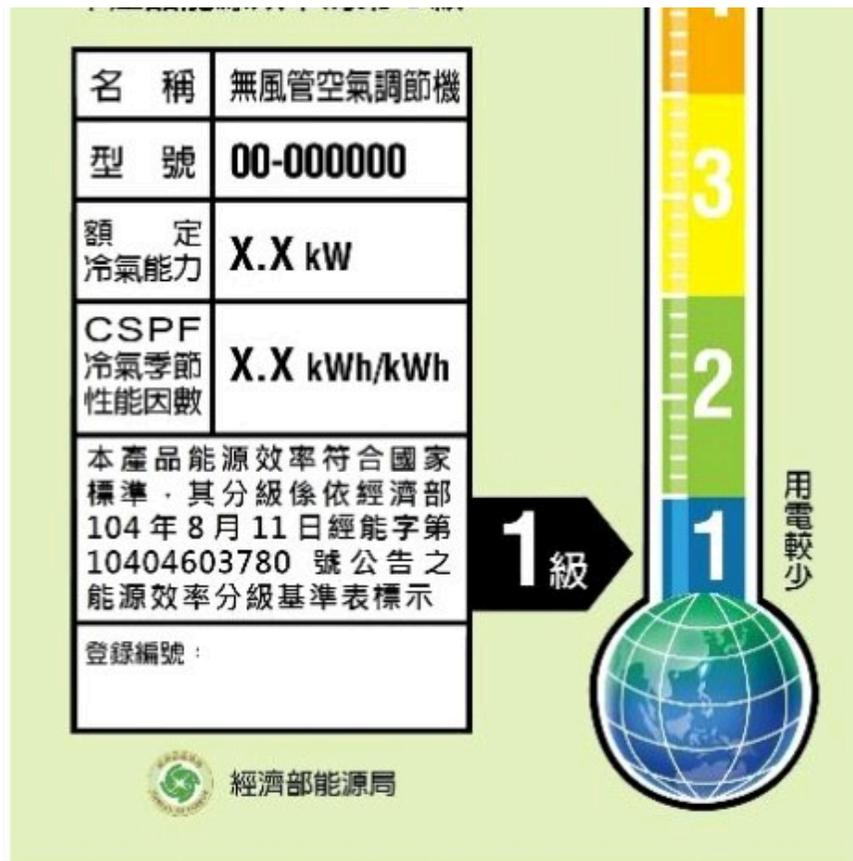
圖8 能源效率等級1級之節能標章示意圖
