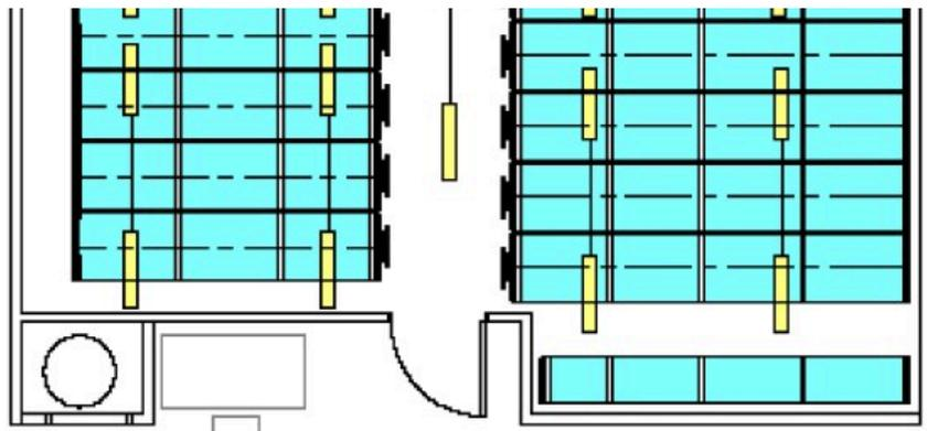
圖3 密集式檔案架燈管安裝位置及方向
