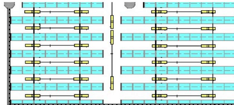
圖4 固定式檔案架燈管安裝位置及方向
