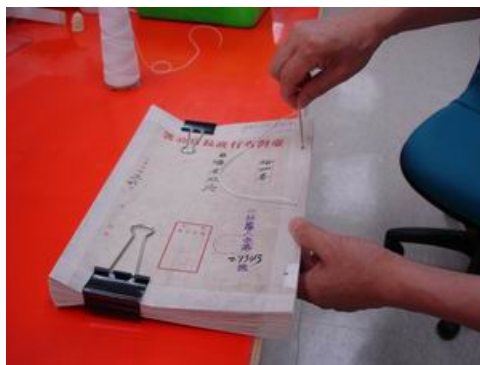
圖13 縫針從第3孔錐眼，由封面向封底穿入
