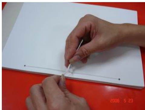
圖16 檔案反面，並將縫線兩端與裝訂線垂直方向拉開後，於裝訂線上打兩次結
