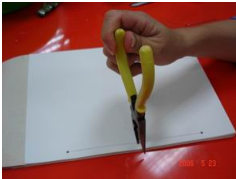
圖18 用尖嘴鉗將線頭篩進孔洞中
