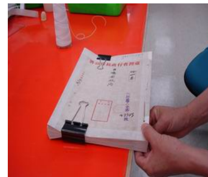
圖14 縫針再從第1孔錐眼由封底向封面穿出
