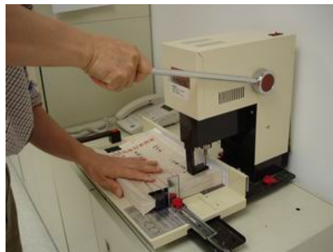
圖10 將已註記孔洞位置之檔案置於鑽孔機上預備鑽孔
