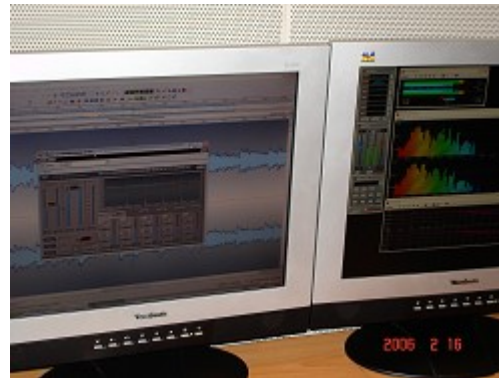
使用動態訊號處理軟硬體，處理數位聲音檔案之動態範圍及音量大小
