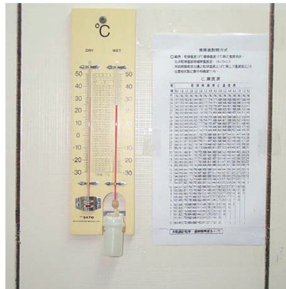
圖 38 乾球溼球溫溼度計
