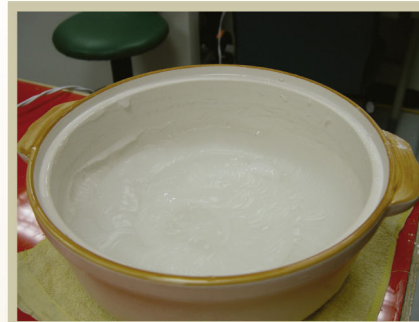
修裱漿糊 4 當澱粉轉成半透明色的凝膠態，即告完成。
