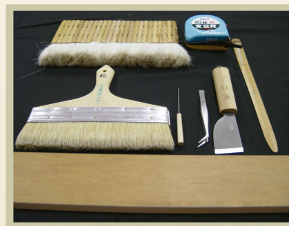
修裱基本工具 毛刷、排筆、裁切刀、裁尺、竹啓子、針錐、鑷子、量尺等。
