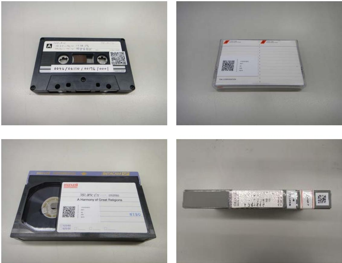
圖 6-7 檔案識別標籤貼覆於錄影(音)帶外殼及容具示意圖
