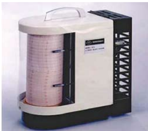
圖 31 機械式溫溼度紀錄器
