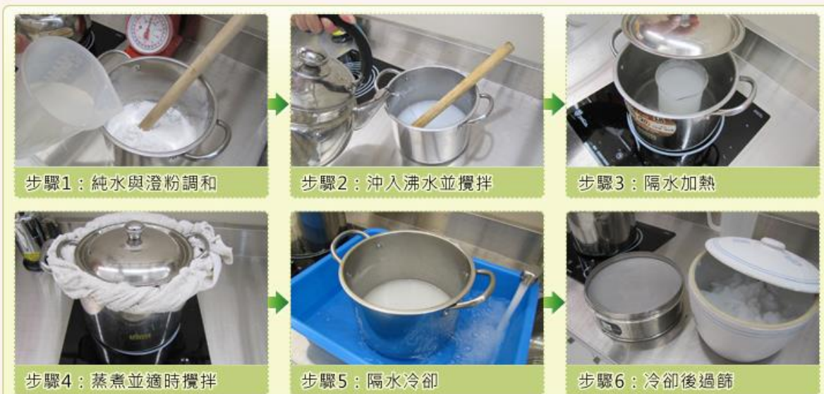
圖2 小麥澱粉漿糊蒸煮法
