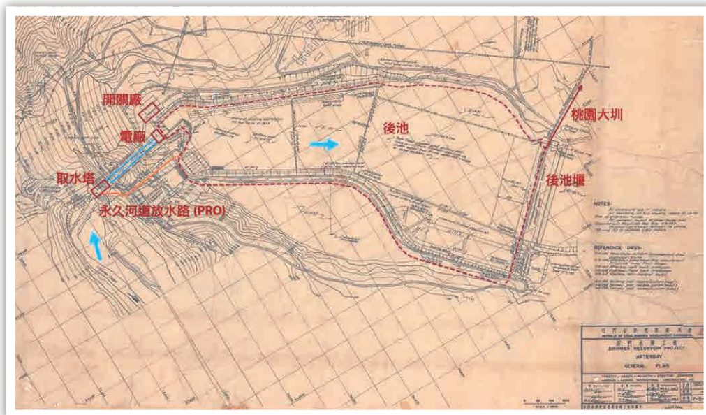
圖 14 取水發電系統與後池平面布置圖
