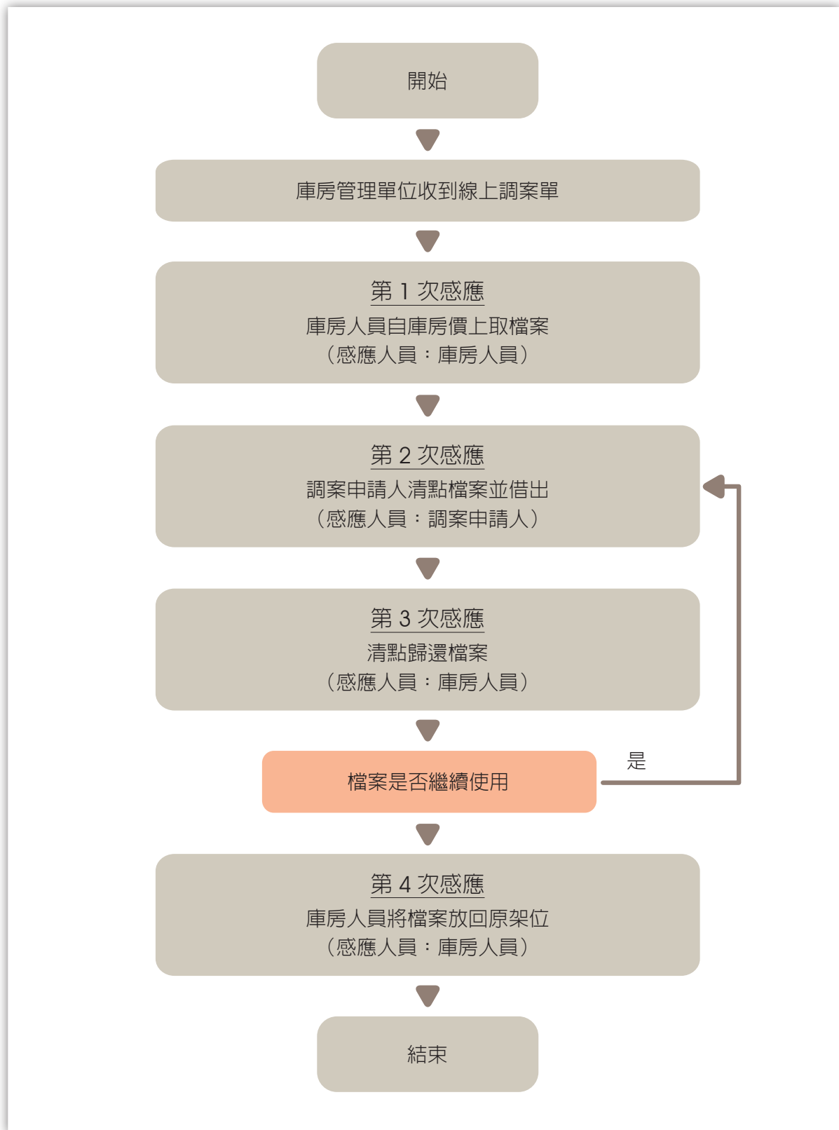
圖 10 檔案借調 RFID 讀取器感應時機流程圖
