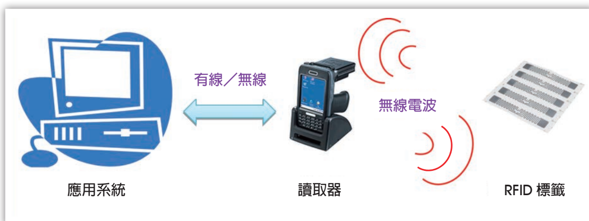
圖 5 RFID 系統傳輸示意圖
