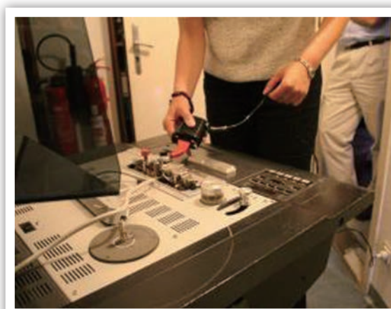
圖 14 娜迪亞示範如何為盤帶機進行消磁
