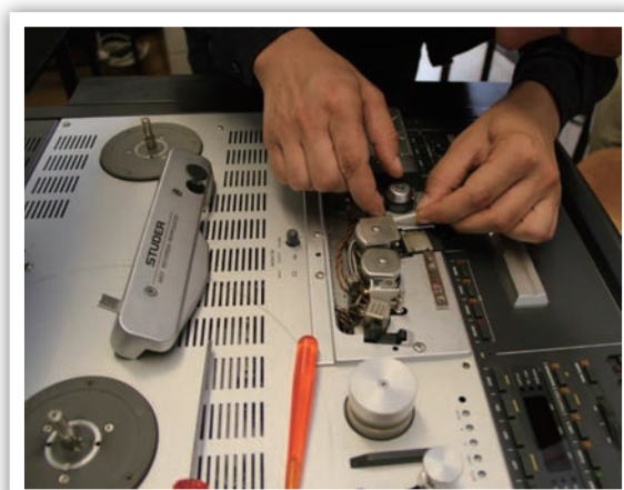
圖 13 盤帶機消磁作業
