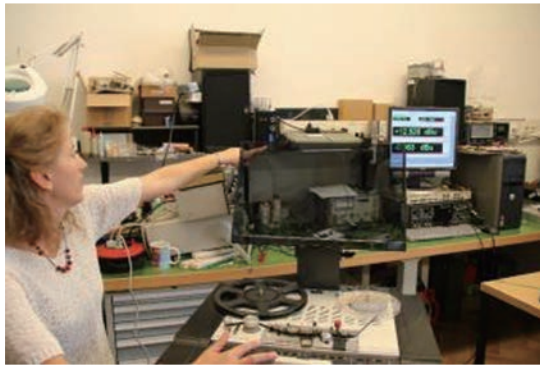
圖 16 以 MRL 測試帶進行校準，並且用示波器檢視校準結果
