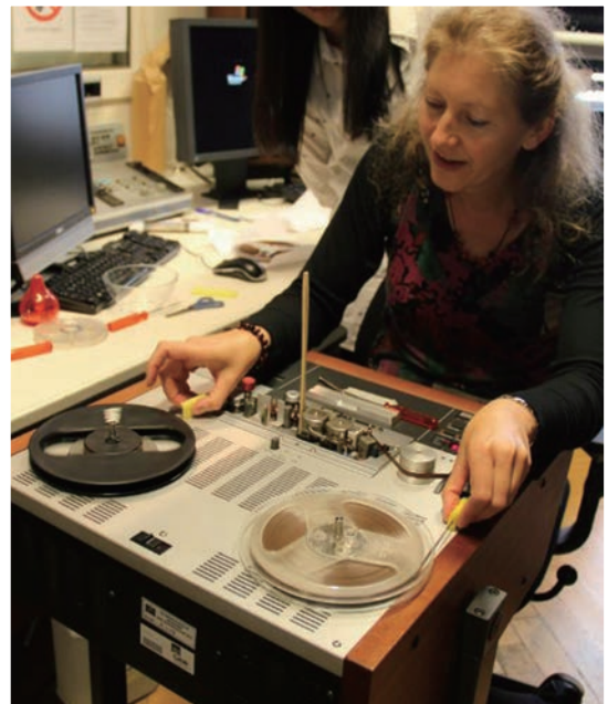
圖 18 使用盤機對磁帶發霉的部分進行清潔
