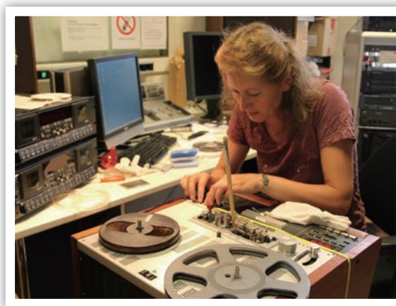
圖 22 類比磁帶數位化轉檔：重新纏繞盤帶
