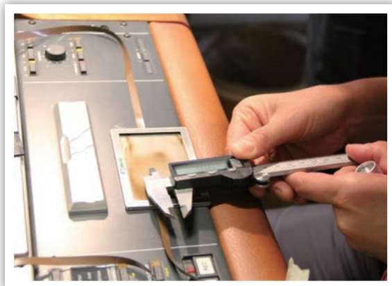
圖 19 類比磁帶數位化轉檔：檢測磁頭規格
