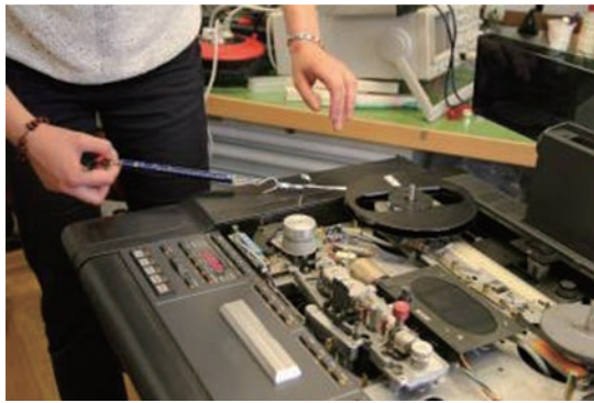
圖 15 測試輪軸的張力
