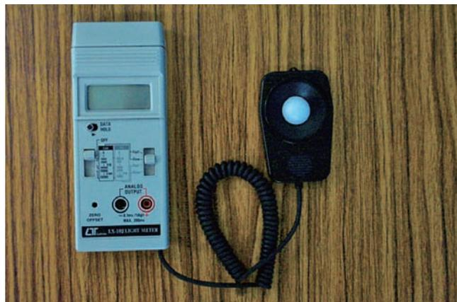
圖 43 照度測量儀器
