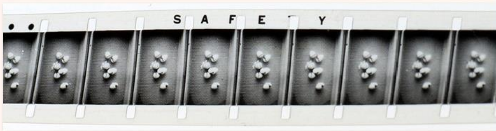
圖3 醋酸片膠卷邊緣SAFETY字樣
