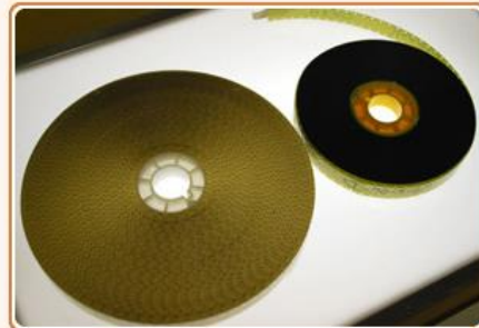
圖5 聚酯片(左)、醋酸片(右) 圖片來源：Preservation Self-Assessment Program網站
